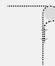
Met koord of sponsrubber, snapping of ring (Intesiv)
